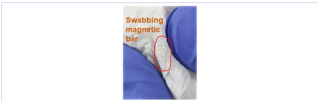
그림 4 마그네틱 봉에 씌우는 플라스틱 덮개가 손상되어 마그네틱 봉에 핵산추출용 마그네틱 비드가 오염됨
